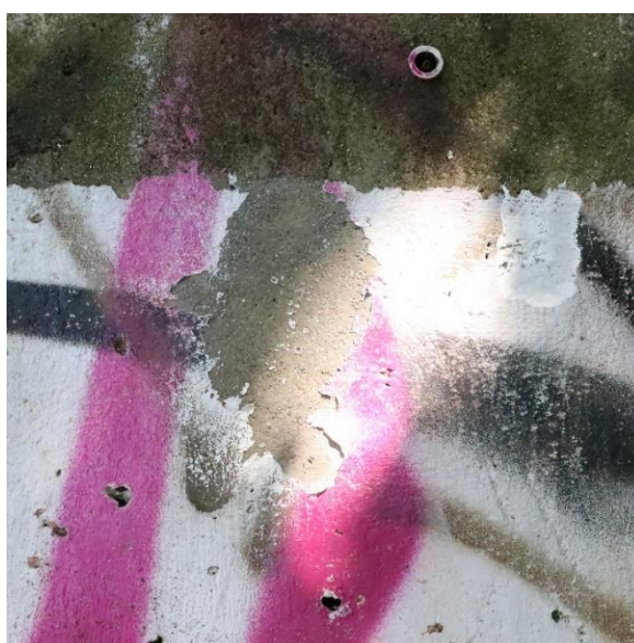
Obr. 20: Zkouška čištění mikroemulzním systémem SDS-EAPC – snímání v oblasti silnějšího bílého nátěru.
